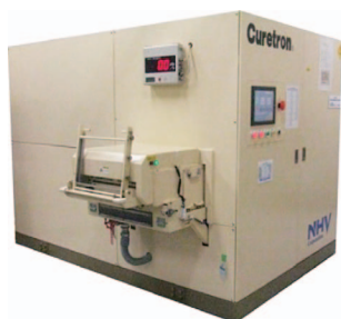
福井大学に設置された電子線照射装置
