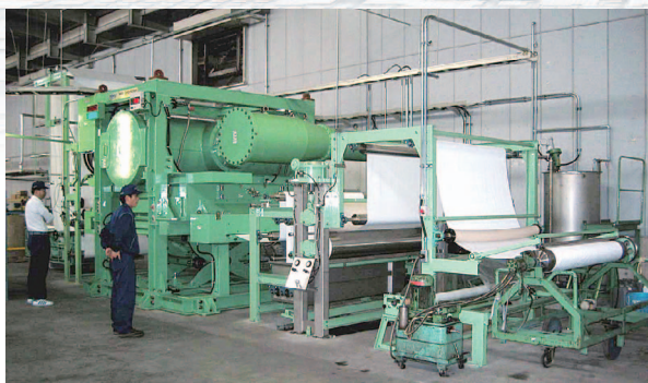
世界初の電子線グラフト重合装置
